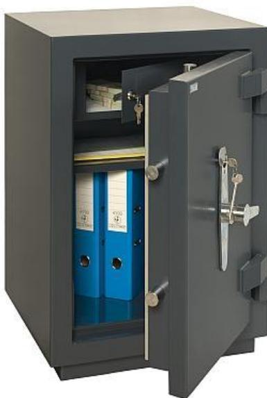
Взломостойкие сейфы серии ПК, сертифицированные по 1 классу взломостойкости, предназначены для хранения денег и документов. Конструкция сейфов представляет сварной двухслойный каркас, заполненный бетоном, что обеспечивает высокую взломостойкость сейфов. Наружная дверь сейфа оборудована хромированным ригельным механизмом. Цвет сейфов серый либо тёмно-серый матовый. Предусмотрена возможность крепления сейфа к полу.
