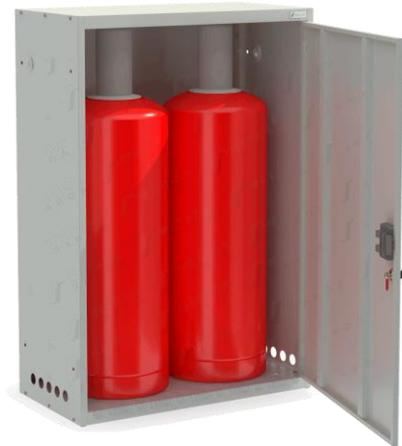
Шкафы серии ШГР изготавливаются из высококачественной конструкционной холоднокатаной стали. Металлический шкаф состоит из сборно-разборного корпуса и одной распашной двери. Корпус состоит из основания, усиленного оцинкованным настилом, крыши, двух боковых стенок и одной задней стенки. Сборка корпуса осуществляется на винтах и саморезах. Дополнительную жесткость основанию придает приварное ребро жесткости.
